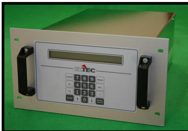
*T-Rack* è un modulo in grado di verificare l'intervento termico negli interruttori automatici magnetotermici e magnetotermici-differenziali. Il sistema funziona come un generatore di corrente sinusoidale costante, e può eseguire anche la prova standard di verifica dell'intervento termico.
